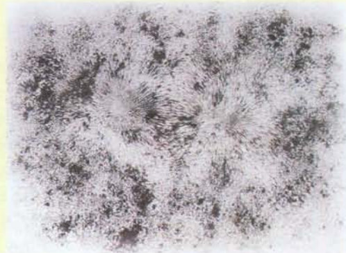
Figura 3.21. Polos de un electroimán
